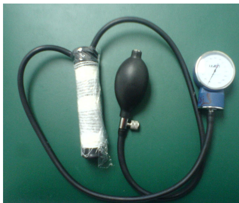
Transductor de presión bucal (tensiómetro modificado)
